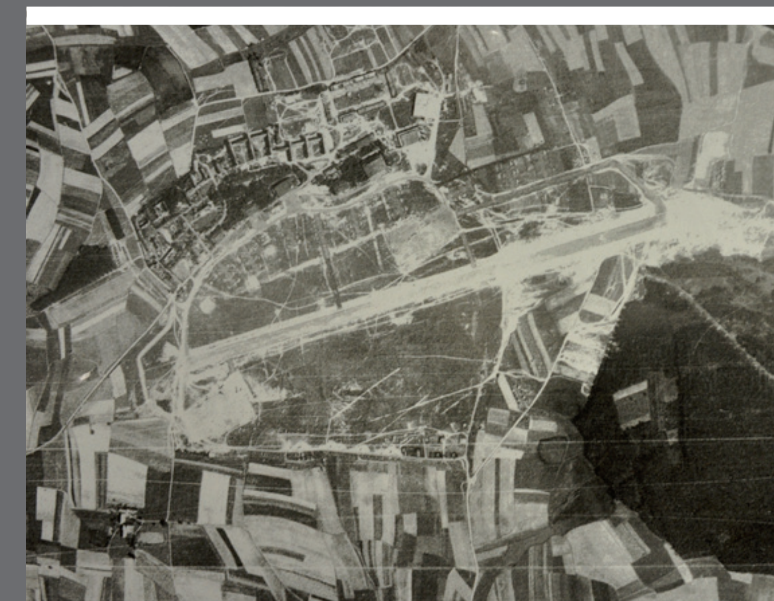
US-Pioniereinheiten hatten die Start- und Landebahn des „Advanced Landing Ground R-29“ auf 2000 Meter verlängert, Luftaufnahme vom 27. August 1945
